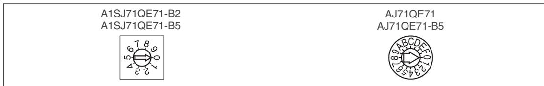
Bei der Auslieferung der Module ist "0" (Online-Betrieb) eingestellt.
